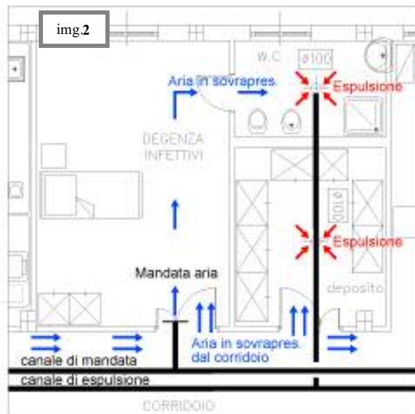
Immagine 1 – Esempio di circolazione dell'aria in una camera di normale degenza – Ospedale di Tirana (Albania)
